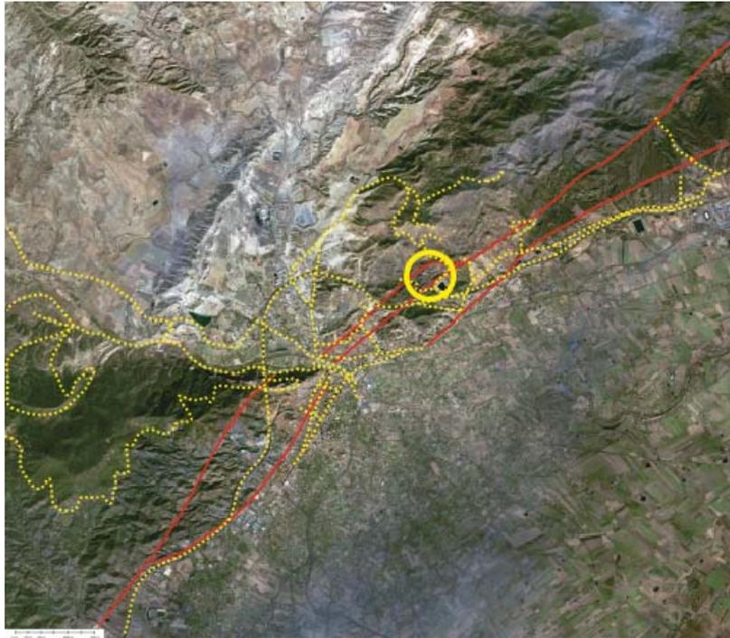
**Figura 5.5.** Imagen de satélite de la zona de Lorca en la que se marca en rojo la posición de la traza superficial de la Falla de Alhama de Murcia, con un círculo amarillo el epicentro del terremoto, y en línea amarilla intermitente los recorridos de inspección realizados hasta el momento con el fin de identificar y cuantificar efectos geológicos superficiales.
