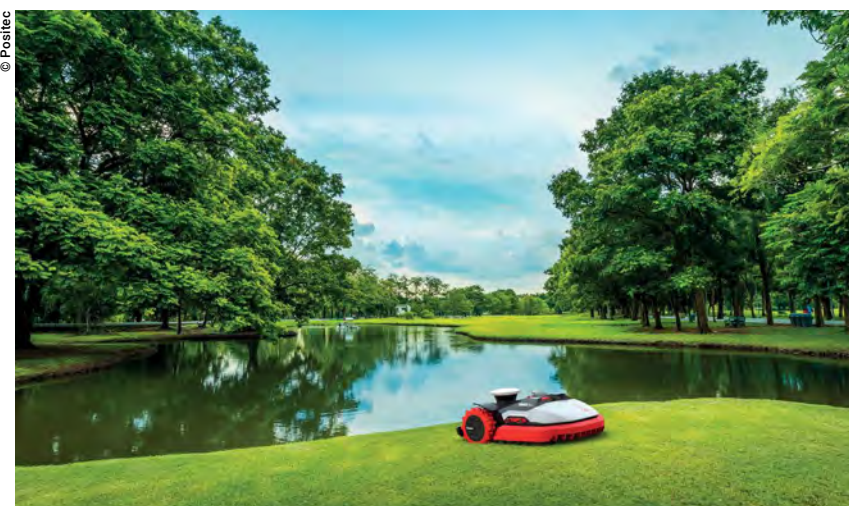
Cortacésped equipado con receptor GNSS.
