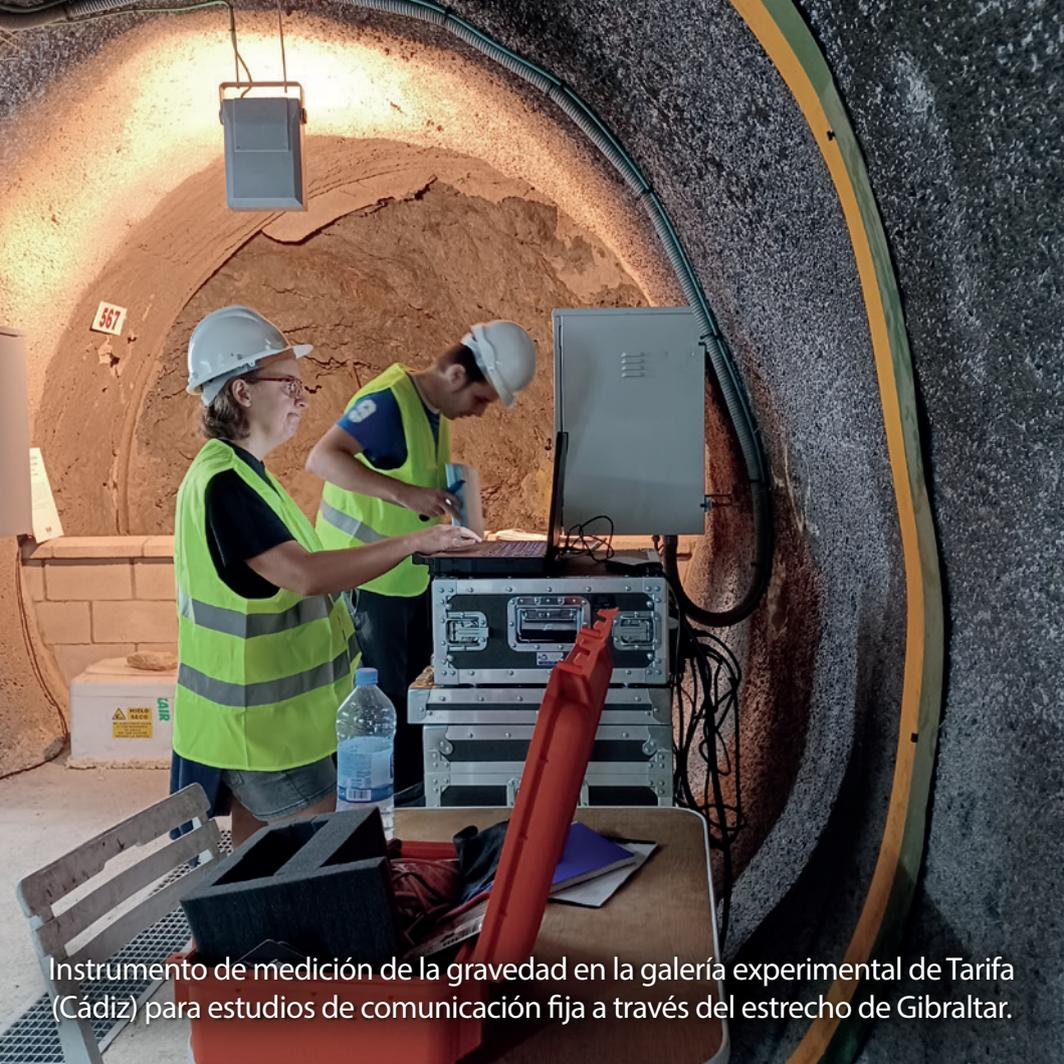
Instrumento de medición de la gravedad en la galería experimental de Tarifa (Cádiz) para estudios de comunicación fija a través del estrecho de Gibraltar.
