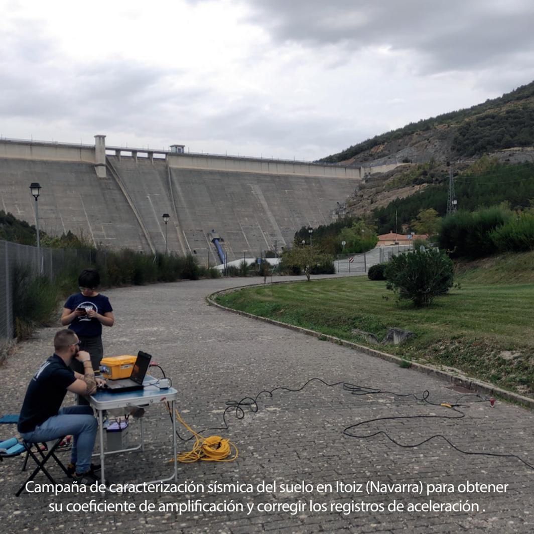
Campaña de caracterización sísmica del suelo en Itoiz (Navarra) para obtener su coeficiente de amplificación y corregir los registros de aceleración .
