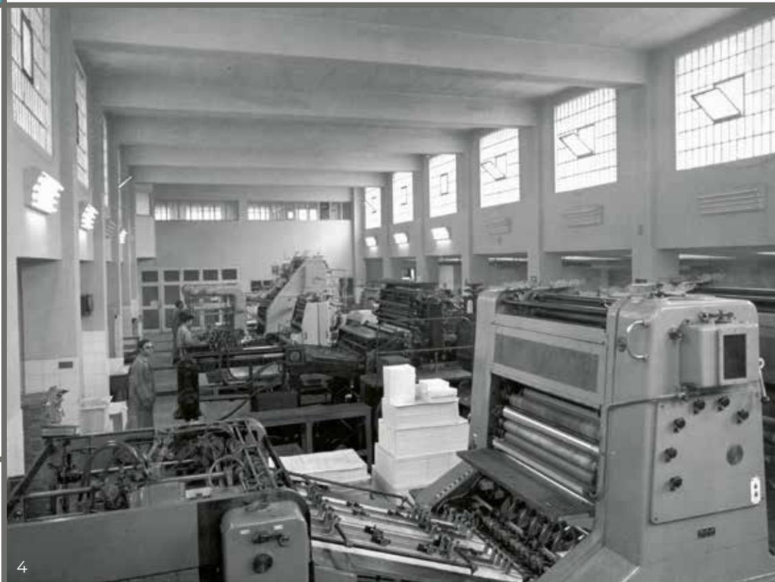
1. Ca. 1950. Máquina de impresión plano-cilíndrica Original Heidelberg.
