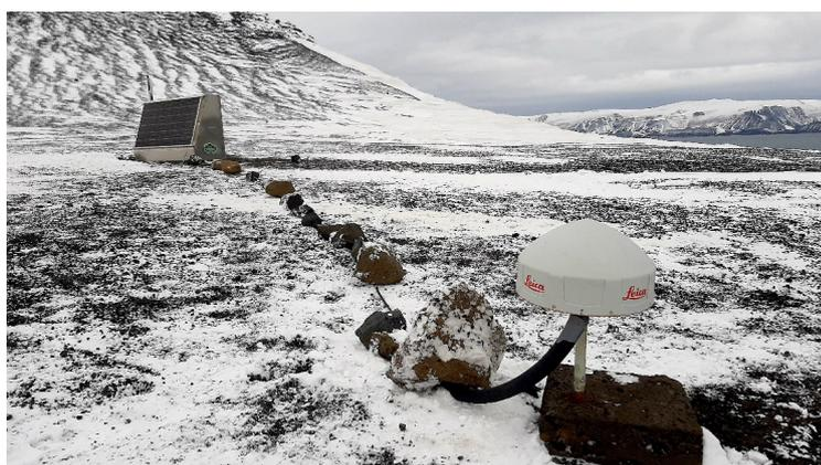
Detalle de estación sísmica y GNSS de Cráteres del 70.
