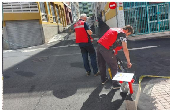
Personal del IGN instalando un sensor de medida de CO<sub>2</sub> en Puerto de Naos, La Palma
