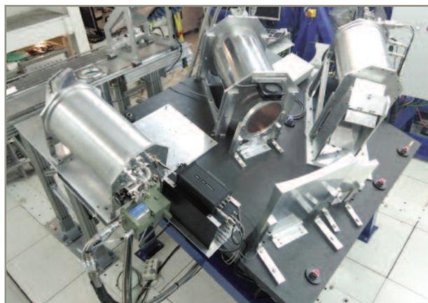
Mesa óptica con los receptores de bandas W, K y Q (de izquierda a derecha).
