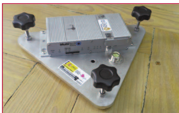
Acelerómetro SILEX basado en tecnología MEMS, de bajo coste, desarrollado por el IGN
