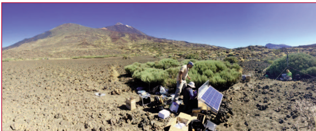
Instalación del array sísmico y uno de los magnetómetros (derecha) en la Caldera de Las Cañadas
