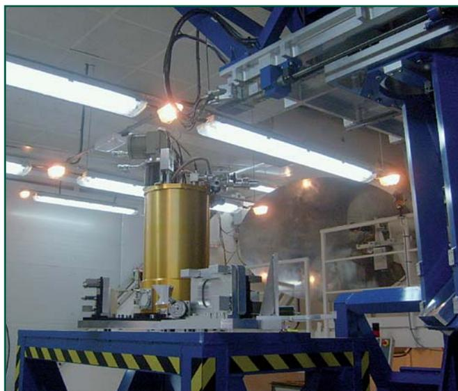
Receptor de banda W (80-120 GHz) instalado en la cabina de receptores del radiotelescopio de 40 m en Yebes
