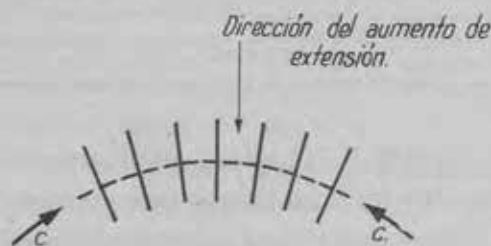
Fig. 11.— En este caso están invertidas las condiciones respecto de la figura 8.ª la compresión es C ; las extensiones son diferentes a uno y otro lado de C .
