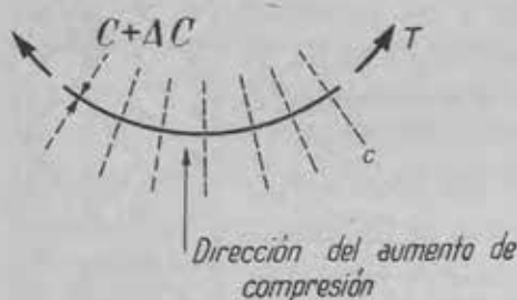
Fig. 8ª. — Líneas isostáticas de compresión (de trazos) y de extensión (líneas sólidas); se cortan ortogonalmente, y la forma de la línea T es la que tomaría un funicular cuyas fuerzas fuesen los aumentos de compresión al pasar de un lado a otro de T .
