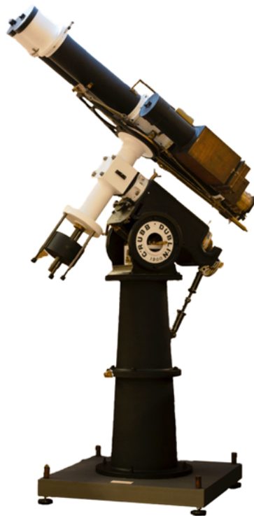
Anteojo ecuatorial de Grubb. Dublín. Hacia 1900 | OAN.
