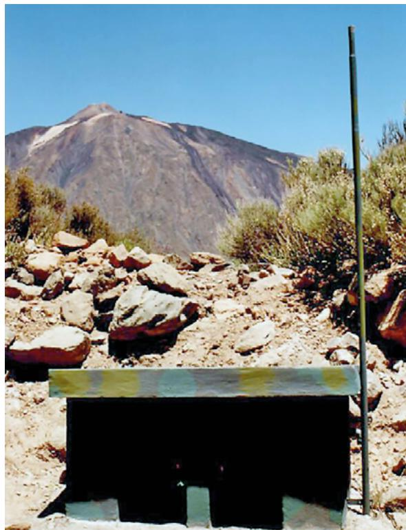
*Figura A1-18. - Estación sísmica CCAN (1990-act.) de Las Cañadas del Teide, con un sismómetro Geotech de corto periodo, de una sola componente (Z). La señal era transmitida en tiempo real al CGC mediante una transmisión mixta radio-teléfono.*
