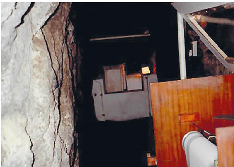
*Figura A1-12. - Estación sísmica (TBT) instalada en una galería en la Caldera de Taburiente de la isla de La Palma, en el año 1974. Se observa a la derecha el registrador Volk in situ en papel tinta. Al fondo se encuentran los sensores.*
