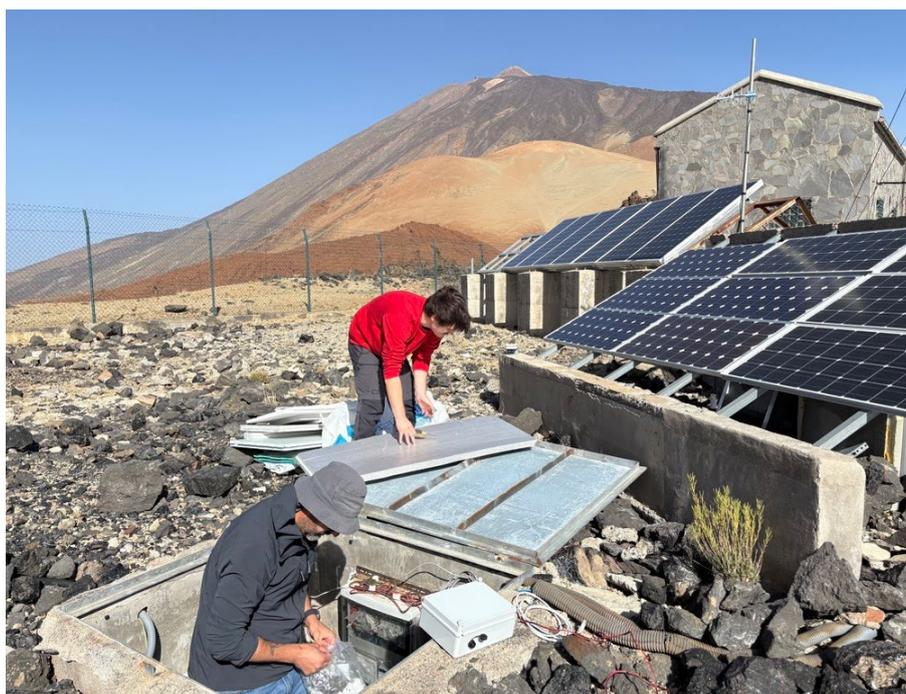
Personal del IGN procediendo a la instalación del inclinómetro IRAJ en las Cañadas del Teide
