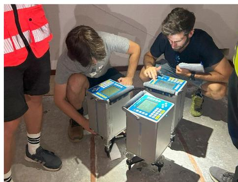
*Instalación de los 3 gravímetros Scintrex en el pilar del chalet, una de las dos estaciones de gravedad absoluta de la red*
