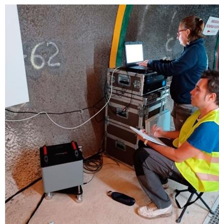
Personal del IGN durante la instalación del gravímetro en la galería experimental de Tarifa
