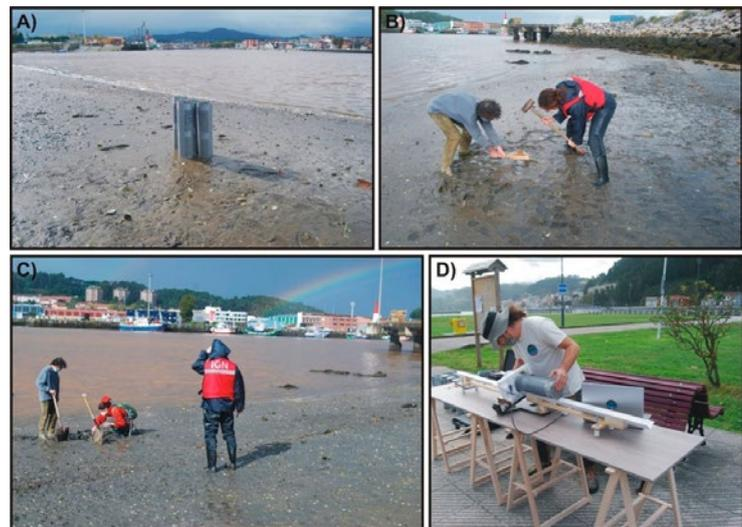
*Figura 1. Proceso de muestreo en la Ría de Avilés: A) Emplazamiento de los 4 tubos de PVC vacíos para la obtención de 4 réplicas; B) Inserción de los tubos en el sedimento; C) Extracción de los tubos con los testigos; D) Medida in situ de la susceptibilidad magnética de los testigos enteros.*
