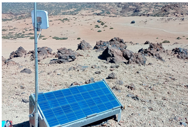
Estructura portátil con panel de alimentación y antena de comunicación por datos móviles
