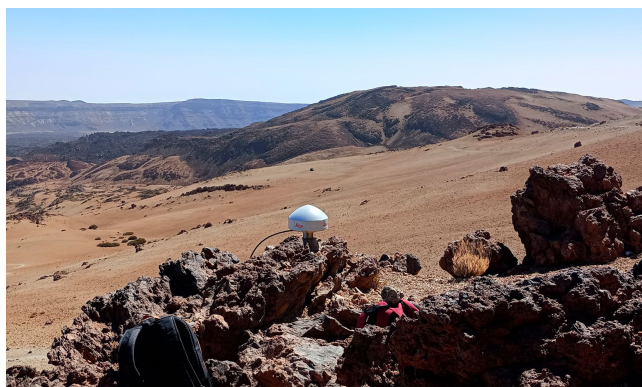
Antena GNSS en la nueva estación TE15. De fondo, Montaña Rajada y las Cañadas del Teide
