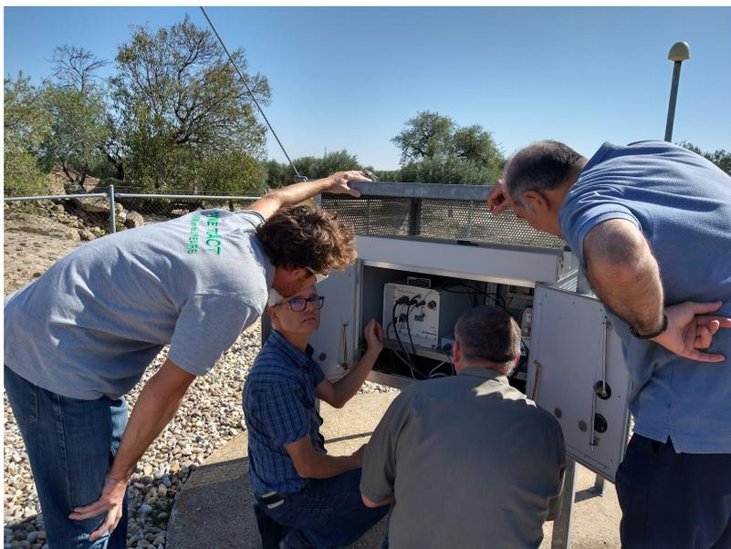
*Técnicos del IGN mostrando la instrumentación sísmica a los técnicos de la OTPCE*
