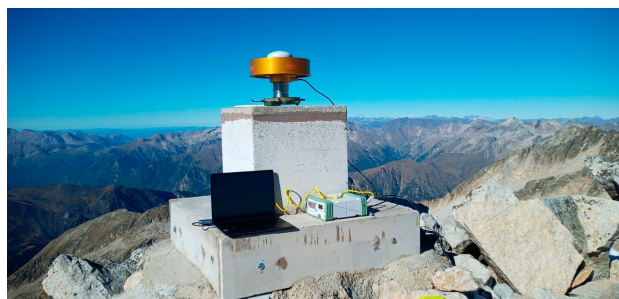
Equipo de medición en el recién construido vértice geodésico en el pico Aneto
