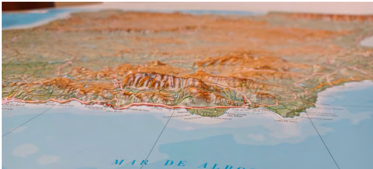
Vista desde el sureste del nuevo ME1250 en relieve (impreso sobre PVC y termomoldeado según el modelo digital del terreno)
