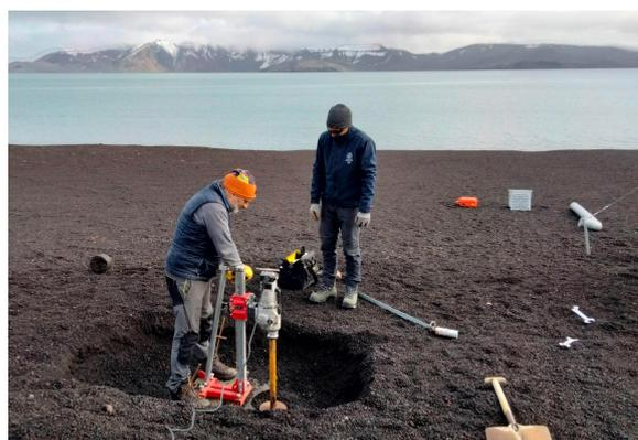
*Realización de un sondeo para la instalación de un sensor sísmico.*
