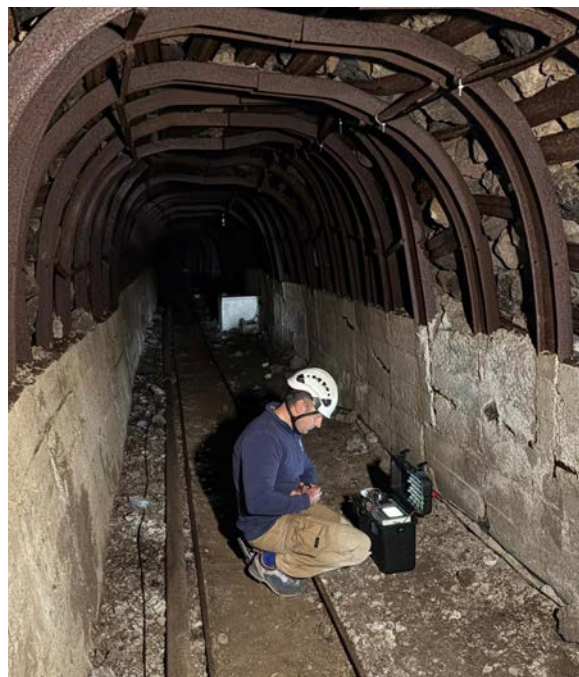
Un ingeniero del IGN en el interior de la galería de Río de Guía configurando el equipo de medida de gases.
