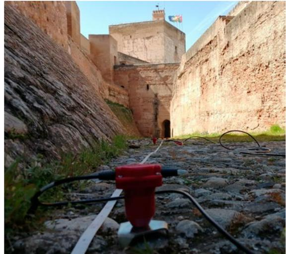
Estas medidas se complementan con registros de ruido sísmico en sismómetros de tres componentes situados en dos o más puntos próximos a la estación. Con ellos se obtienen las razones espectrales horizontal-vertical (método Nakamura o HVSR), las cuales permiten estimar la frecuencia fundamental del subsuelo de la estación, que es también, junto con las velocidades V<sub>s</sub>, un parámetro de interés para la caracterización sísmica del emplazamiento.
