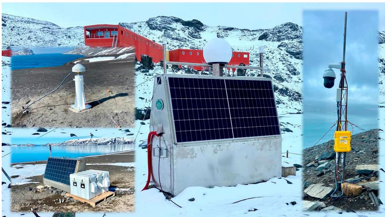
*Centro -Estación multiparamétrica instalada en la Base Juan Carlos I que incluye una estación sísmica una estación GNSS, una cámara web de vigilancia y un sistema energético mixto con paneles solares y una pila de metanol. Izqda. arriba – Nueva estación GNSS. Izqda. abajo – Nueva pila de metanol junto con caseta con panel fotovoltaico Derecha - Cámara web bi-espectral, visual y térmica, para el seguimiento de la actividad volcánica de la Isla Decepción.*
