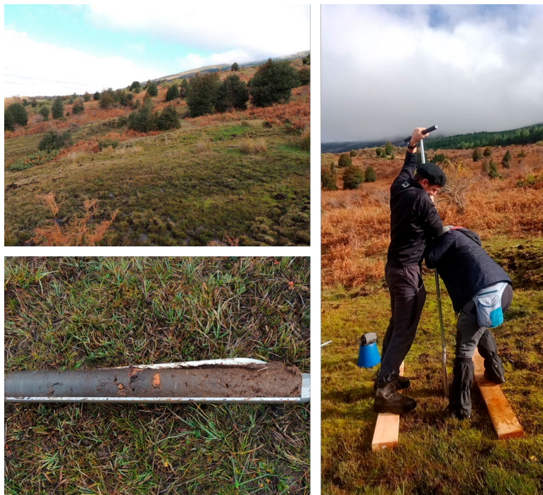
Extracción de testigos de turbera en la acebeda de Prádena (Segovia) mediante un sondeador Russian Corer .
