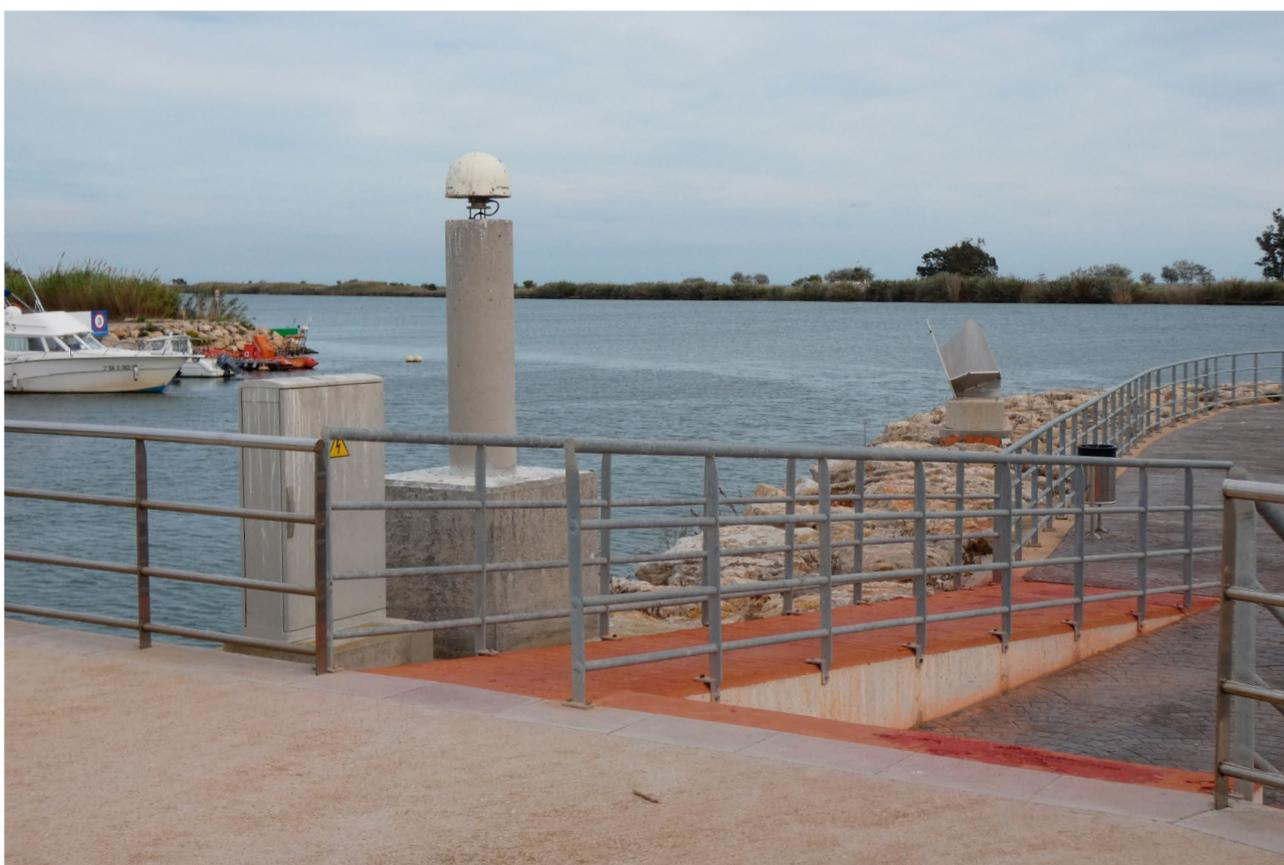
Estado actual de la estación permanente GNSS del Delta del Ebro
