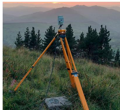
*Midiendo la diferencia de potencial con magnetómetro de protones en Esles (Cantabria)*
