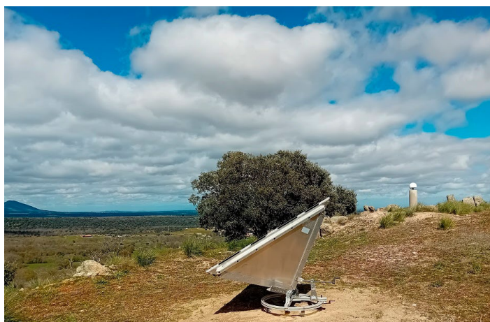
Vista del reflector para calibración instalado. Al fondo de la imagen se puede ver la estación SPAB de la ERGNSS del IGN.
