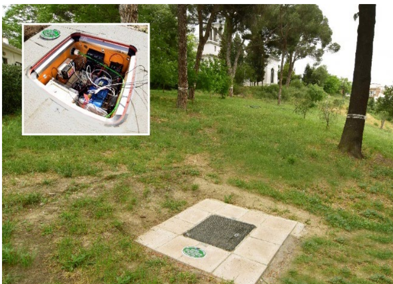
Estación sísmica de medida de la aceleración en campo libre instalada en los jardines del Real Observatorio de Madrid
