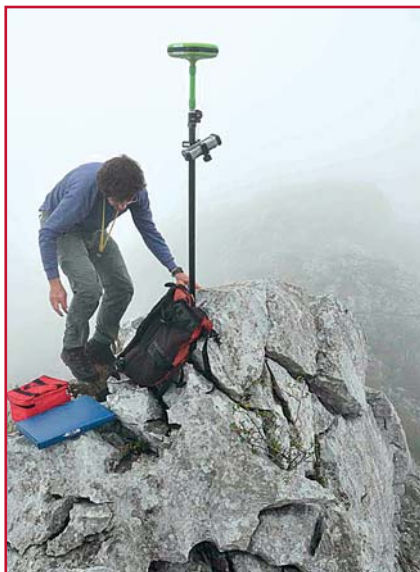
El ingeniero D. José Manuel Pérez Casas realizando la medición de coordenadas en uno de los mojones
