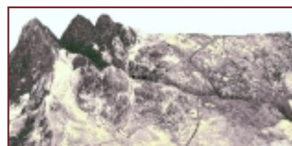
Superposición de MDT e imagen de la hoja 483-3 del MTN25, «La Losa», proporcionados por el sensor Lidar. Perspectiva norte-sur (Segovia-Sierra de Madrid).
