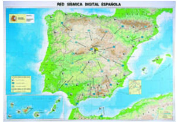
Distribución de las Estaciones Sísmicas de Banda Ancha de la Nueva Red.
