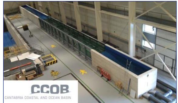
Instalaciones para la simulación de tsunamis en la Universidad Politécnica de Cantabria
