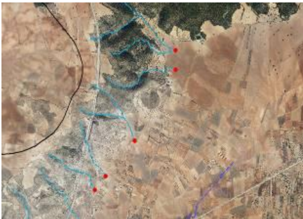
Bocas de hidrografía en ríos en los que se pierde el trazado en una zona muy llana
