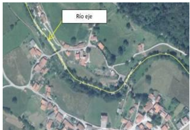
Eje dentro de tramo superficial (ancho > 5m)
