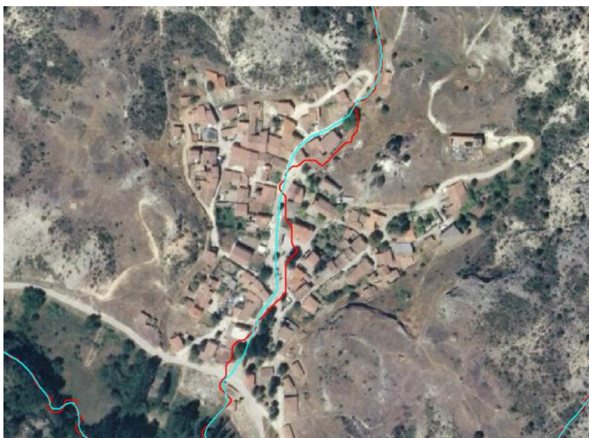
En la imagen se ha corregido el trazado del río para que no atraviese los edificios. En rojo la red automática, en azul el cauce correcto editado
