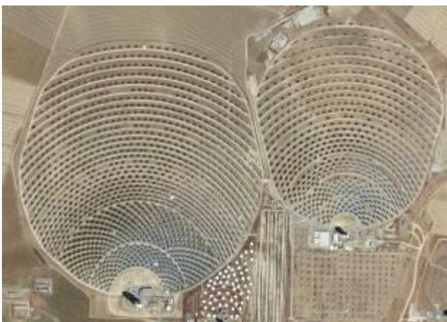
Central termosolar con espejos que concentran a una torre
