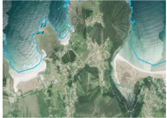
Línea de costa en cota 0, desplazada de la línea tierra-mar visible en la ortofoto
