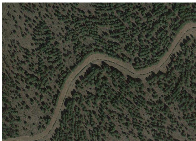
Cortafuegos mantenido en zona con arbolado disperso
