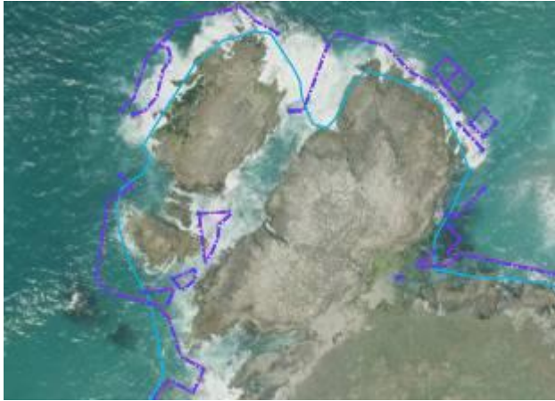
Curva de cota 0 obtenida con MDT (morado) y línea de costa en cota 0 resultante (azul)
