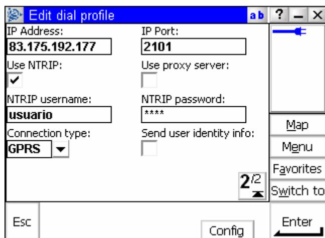
Una vez ya creado el nuevo perfil de marcado puede definir un nuevo estilo de levantamiento. Para ello vaya al menú *Configuración* y luego en *Estilos de levantamiento*.
