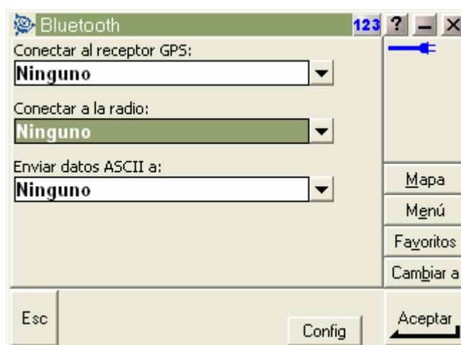
Desde el menú *Configuración*, seleccione *Estilos de levantamiento* y cree un estilo nuevo al que le tendrá que dar un nombre y definir el *Tipo de estilo* como *GPS*. Al finalizar pulse *Enter*.
