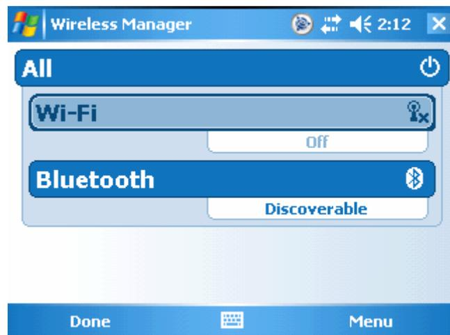
Por defecto la radio Wi-Fi estará desactivada. Para activarla pulse sobre *Off* y le aparecerá una lista con todas las redes Wi-Fi detectadas. Seleccione la suya y pulse *Ok*. Cuando se le pregunte indique que la conexión a crear es de tipo *Internet*.
