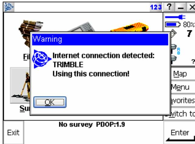
A continuación pulse en *Iniciar levantamiento* y *Survey Controller* conectará con el cáster Ntrip de la red de estaciones permanentes a la que se va a conectar. Le aparecerá un listado con todas las conexiones disponibles en ese cáster. Usted sólo tiene que seleccionar la conexión que desea utilizar y el programa se conecta automáticamente.
