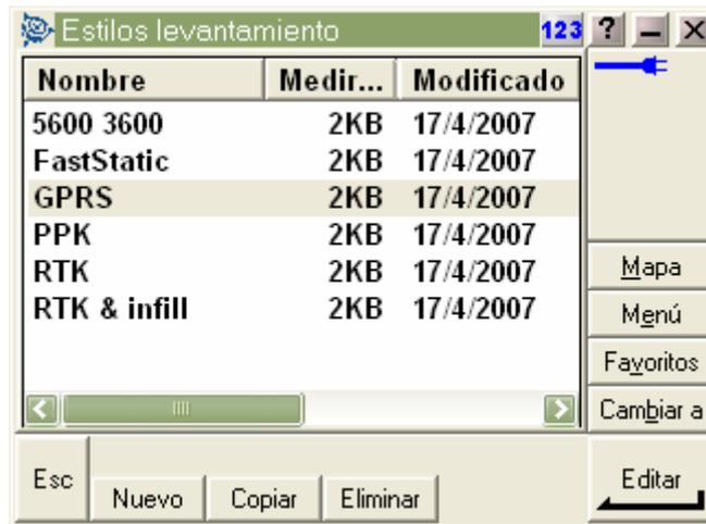
Para iniciar un levantamiento utilizando la conexión NTRIP pulse en la pantalla principal de *Survey Controller* el menú *Levantamiento*. Le aparecerá el listado de estilos de levantamiento disponibles, entre los que se encontrará el que ha creado para trabajar con NTRIP. Pulse sobre ese estilo de levantamiento y luego seleccione *Iniciar levantamiento*.
