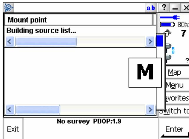
Si la conexión funciona correctamente deberá aparecer un símbolo en forma de T invertida de color rojo en la barra de estado de *Survey Controller* (arriba a la derecha). En pocos segundos el receptor habrá inicializado y podrá comenzar a trabajar con su receptor móvil.
