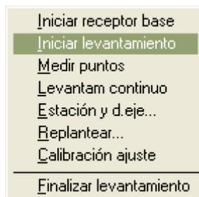
Aparecerá un mensaje en el que se avisará de que se va utilizar la conexión a Internet que hay activa. A continuación aparecerá un listado que le muestra la información del cáster NTRIP al que se conecta y podrá ver todas las conexiones disponibles, tanto a estaciones simples como a VRS. Seleccione alguna de ellas y en pocos segundos el levantamiento se iniciará.
