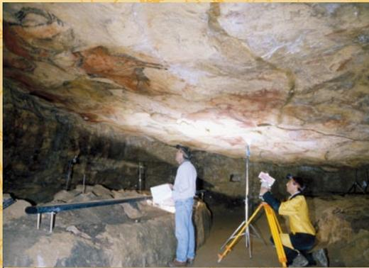
*Medición de puntos de apoyo en la sala de policromos.*
