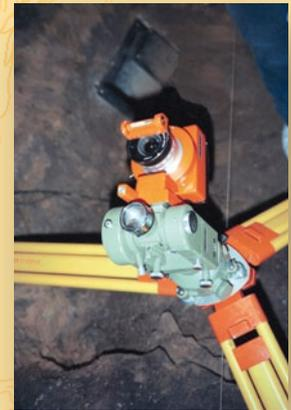
Las dificultades previsibles para lograr el recubrimiento estereoscópico del techo de la sala de Polícromos (obstáculos existentes, irregularidad del suelo, material de investigación, así como la pequeña y variable distancia de techo-suelo que oscilaba entre 2 metros y 0,70 metros) hizo necesario realizar un proyecto riguroso en función de la focal de la cámara, dimensiones de la película, alturas de techo.
