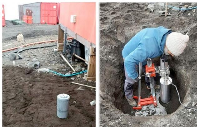
*Sondeo de unos 2 metros de profundidad en el que se sitúa el sensor sísmico de banda ancha para eliminar el ruido de las rachas de viento y garantizar su aislamiento.*
