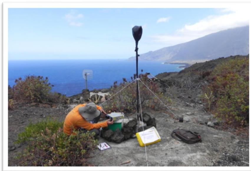
*Instalación de magnetómetro*
