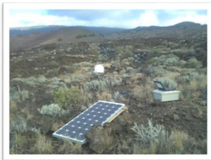
*Estación permanente GPS para el control de deformaciones en la isla de El Hierro*
