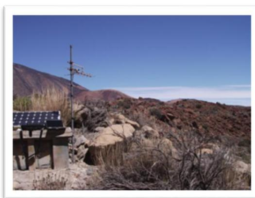
*Estación sísmica en Las Cañadas del Teide (Tenerife) vía radioenlace*
