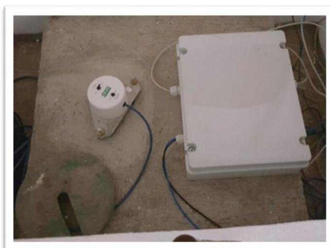
*Inclinómetro de superficie de dos ejes con colector de datos*
