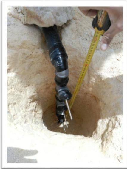
*Instalación de perfil vertical de temperatura*
