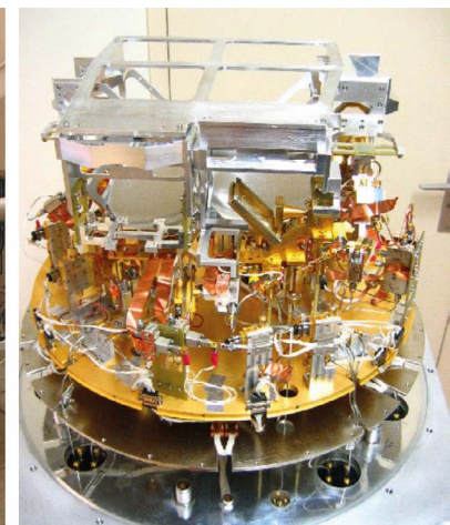
El receptor EMIR de cuatro bandas permite cubrir desde 70 hasta 370 gigahercios. A la derecha, su interior durante el montaje en laboratorio.
