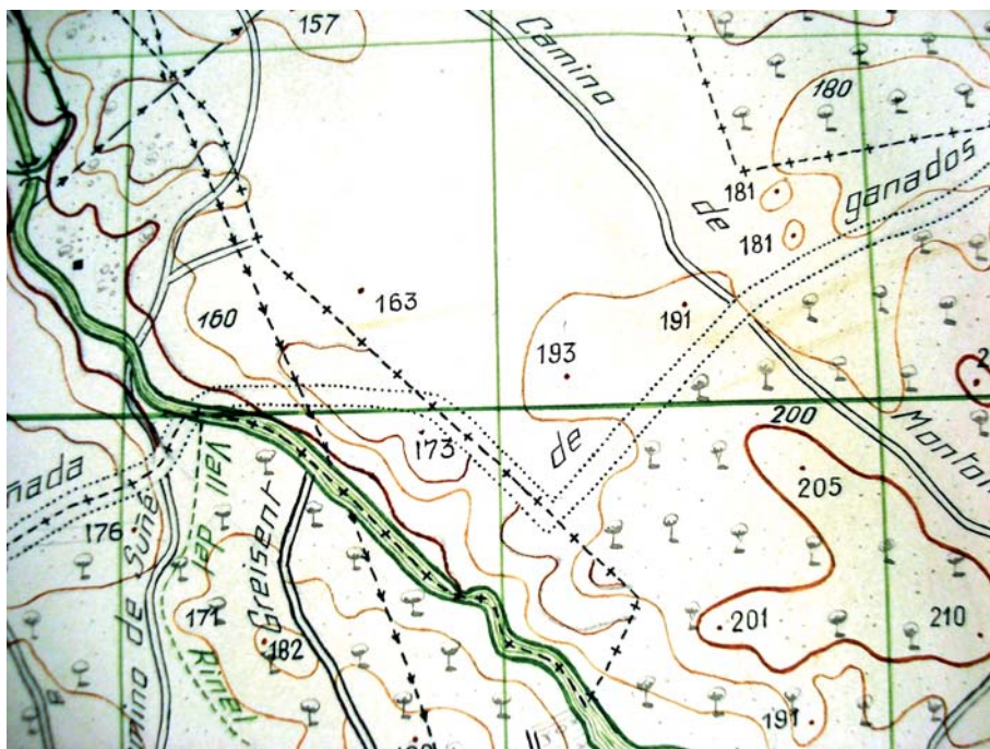
Figura 4.7. Detalle de la minuta de la hoja 388-III (Alcaraz) del Plano Director a escala 1:25.000. Puede observarse la interrupción de la mitad de las curvas de nivel en el contacto de determinados municipios. Fuente: España. Ministerio de Defensa. Archivo Cartográfico y de Estudios Geográficos del Centro Geográfico del Ejército.
