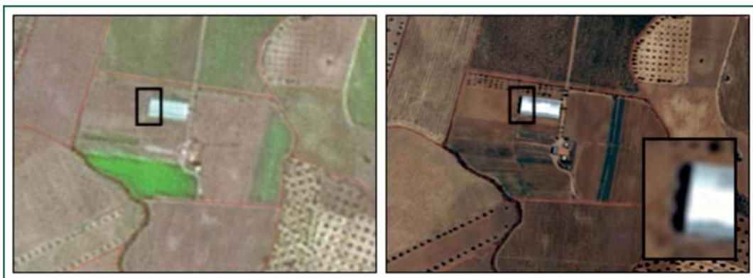
Figura 67: Estructura tipo nave o invernadero en una zona agrícola al SE del término municipal de Malagón, Ciudad Real. En la ortofotografía PNOA se aprecia que la sombra que proyecta el tejado de esta infraestructura está compuesta por tramos semicirculares (al oeste), muy infrecuente en las naves agrícolas, por lo que se puede determinar que es un invernadero (cultivo FORZADO). Mosaico SPOT (escena 34-271) de junio de 2005 y ortofotografía PNOA de julio de 2006.
