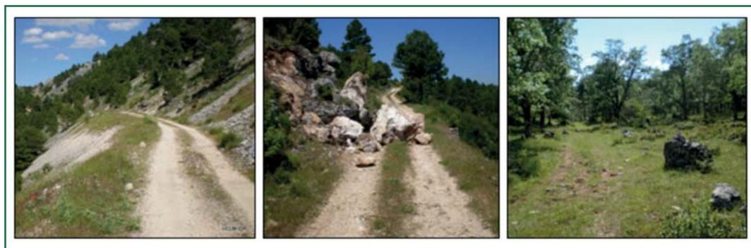
Figura 95: Izquierda: zona de alta montaña con camino a mitad de una ladera con una elevada pendiente con alto riesgo de desprendimientos. Centro: camino obstruido por un desprendimiento de rocas. Derecha: camino en vías de desaparición.
