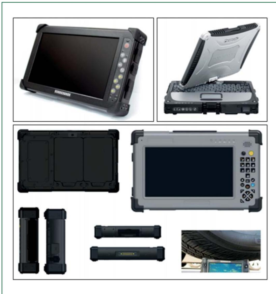
Figura 19: Arriba izquierda, tablet PC ruggedizada con pantalla retroiluminada (ruggedbook, [www.ruggedbook.com](http://www.ruggedbook.com)). Arriba derecha, tablet PC ruggedizada (toughbook), certificado por estándares militares, MIL-STD-810G ([www.panasonic.com](http://www.panasonic.com)). Abajo, tablet PC ruggedizada utilizada y diseñada para uso militar (EMC Madrid, [www.emc.es](http://www.emc.es)).
