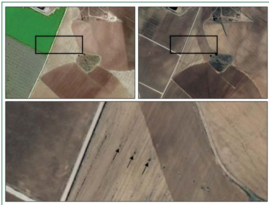
Figura 63: Arriba, parcelas aparentemente de secano en el término municipal de Tobarra, Albacete. Abajo, imagen ampliada donde se han remarcado los hidrantes de las tuberías secundarias (distanciadas aproximadamente 17,5 m), lo que nos muestra que es una parcela de REGADÍO NO REGADO. Mosaico SPOT (escena 38-272) de julio de 2005 y ortofotografía PNOA de julio de 2006.
