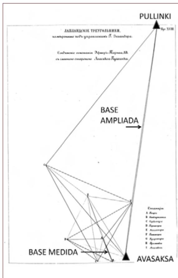
Base medida (AB) y base ampliada (Avasaksa-Pullinki). Para calcular la longitud de la segunda se resolvieron todos y cada uno de los triángulos que formaron la red de enlace entre ambas (red de ampliación de base).
