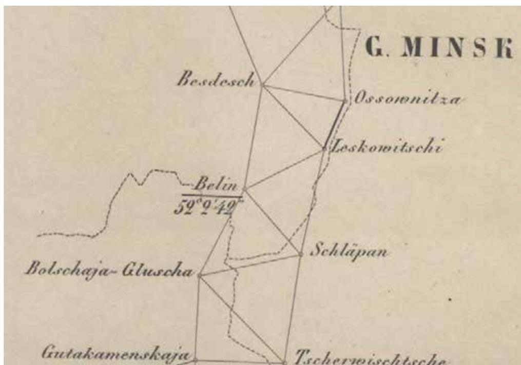
Triángulos geodésicos en los alrededores del vértice Belin.
