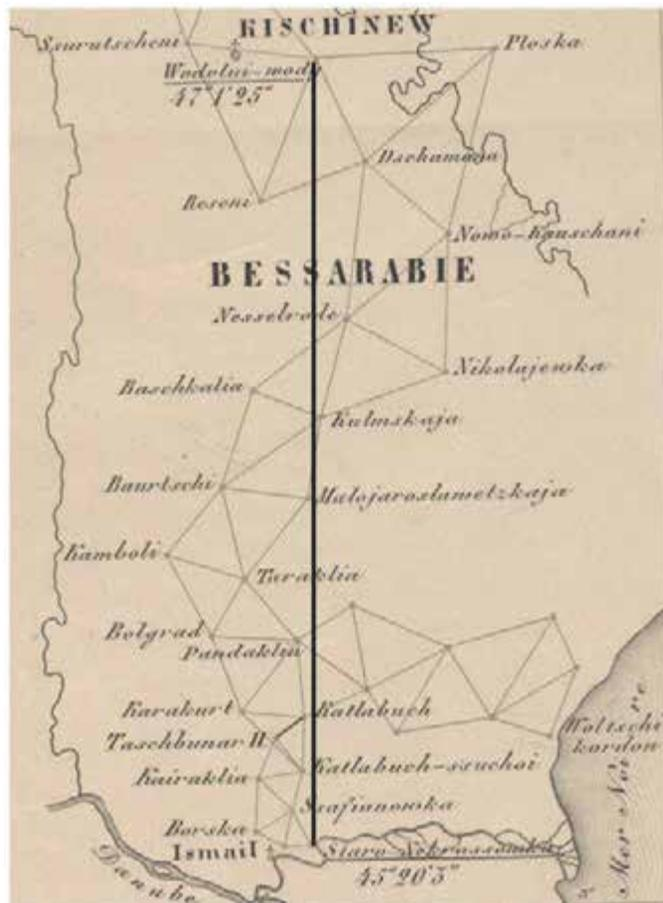
Triángulos polares del arco meridional, con origen en la estación Staro-Nekrassowka.
