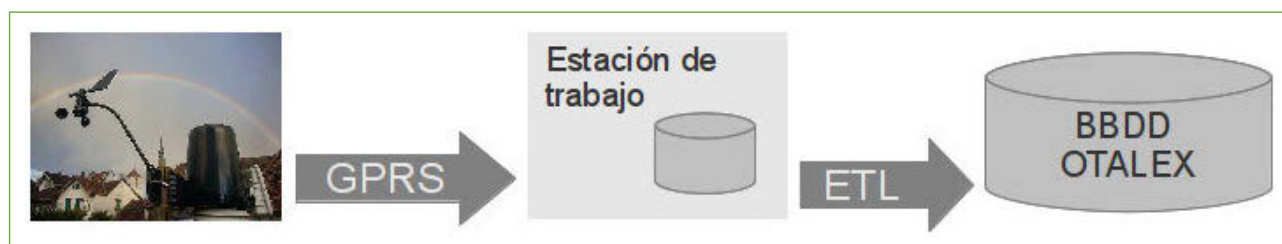
Figura 3. Transferencia de información de la estación meteorológica.
