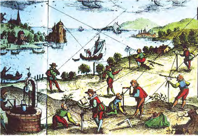
Ilustración de la obra de Cornelius de Judaeis y Levinus Hulsius De quadrante geometrico libellus (1594), en la que se utilizan diferentes instrumentos y métodos topográficos. Se efectúan observaciones para determinar la profundidad de un pozo, la altura de una torre, la latitud al observar estrellas e incluso bisecciones.
