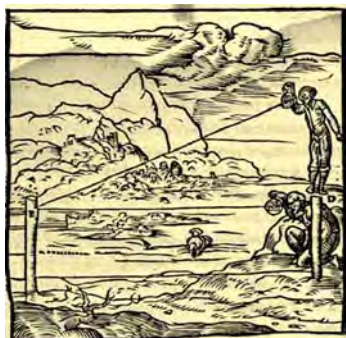
Medida de distancias con astrolabio en la obra de Johann Stoeffler Elucidatio fabricae vsusque astrolabii (1553). Fuente: FDUS.
