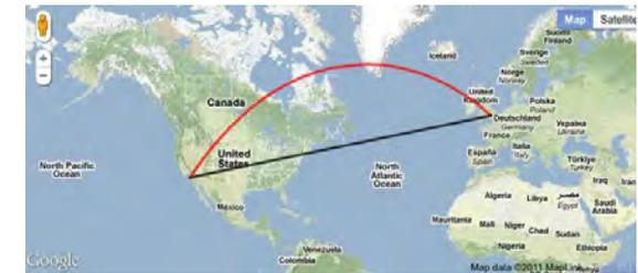
Figura 14.13. Opción polilínea geodesic : true conecta dos puntos a través de un círculo máximo, la distancia más corta entre dos puntos de la esfera. Aparece como una línea más larga en este mapa, debido a la proyección. (© 2014 Google).
