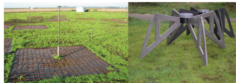
Figura 1: Elementos del interferómetro LOFAR. A la izquierda los dipolos de baja frecuencia (30–90 MHz), a la derecha los de alta frecuencia (110–240 MHz). Fotografías cortesía de www.lofar.org .
