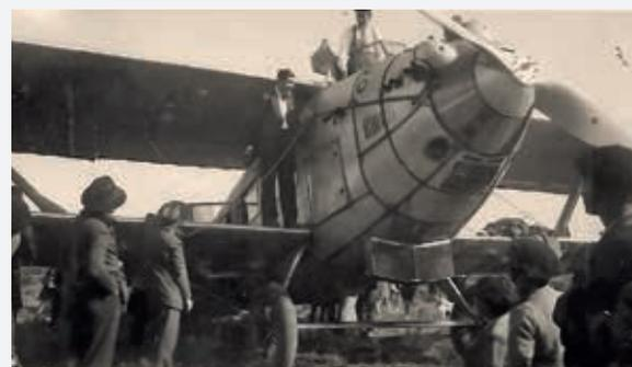
*Avión Breguet 26-T (matrícula EC-HHA) utilizado a partir de 1930 para trabajos de fotogrametría aérea. Este aparato sería derribado durante la Guerra Civil.*
