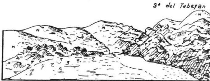
Figura 1.— Vista del embalse del Vinalopó a 13 kms. al N. de Elche. *M* = Mioceno (margas fuertes y pudingas). *T* = Triásico (margas con arcillas y filones yesíferos del Keuper).
