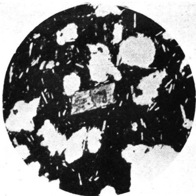
Fig. 56.—Basaltita del O. de la carretera. Luz polarizada por 100 aumentos. En el centro, un cristal de augita. Microlitos de labradorita (en blanco, formas alargadas). Vacuolas (en blanco, formas irregulares). Vidrio de la pasta (en negro).
